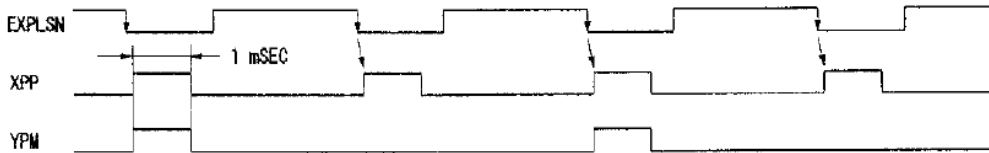
图 2.4.6 根据外部信号(EXPLSN)的步进插补例子(驱动速度: 500PPS)
